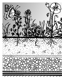
Drenázs feltöltés Drainage filling
