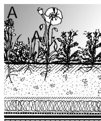
Szűrő-szivárogtató paplan Filtering-draining quilt
